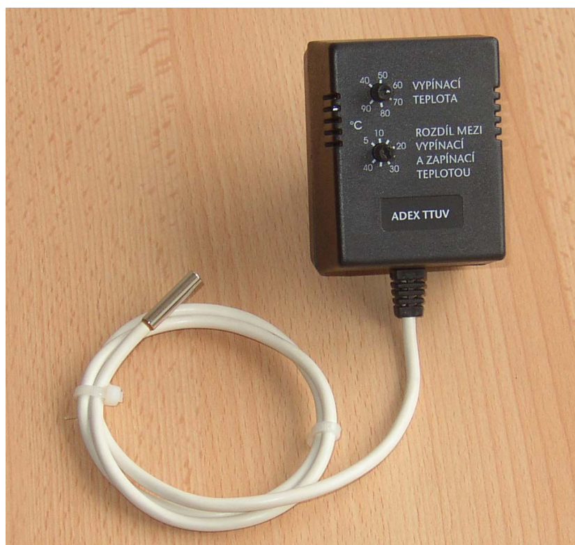
Obr.2 Pohled na termostat s teplotním čidlem
